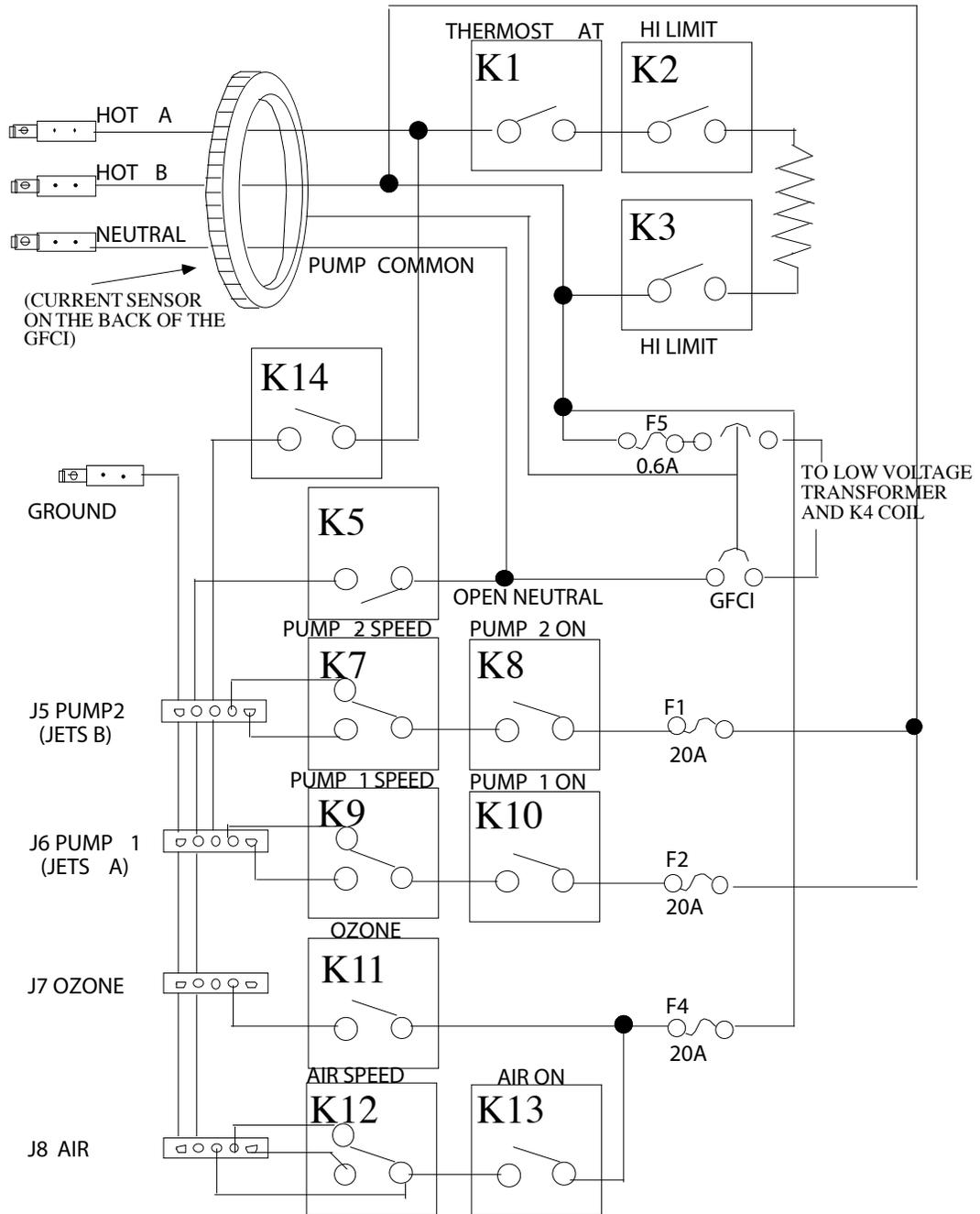
ELECTRICAL CONNECTION FOR ELECTRONIC CONTROLS
